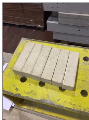
**Figura 5.6 - Provetes de argamassa prontos a ensaiar**
