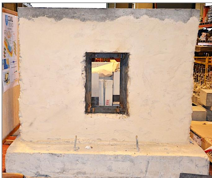
**Figura 5.14 - Aspeto final da parede reforçada**
