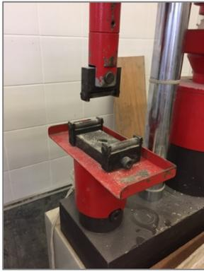
**Figura 5.7 - Ensaio de flexão de provetes de argamassa**
