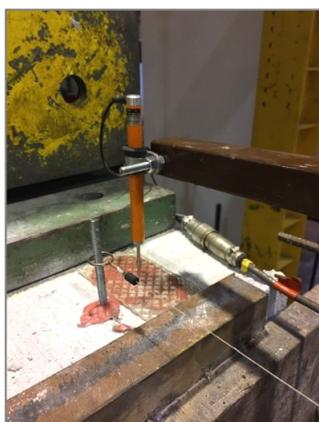
**Figura 5.21 - LVDT(d4) e ligação do fio do LVDT(d12) à parede**
