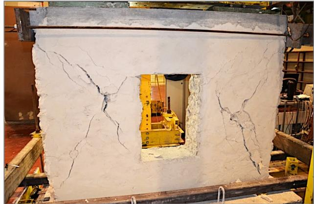
**Figura 5.29 - Primeira vez que se atingiu -18 mm de deformação (semi-ciclo 24)**
