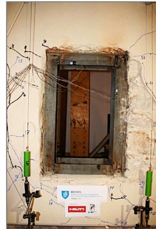
Figura 5.32 - Quadro metálico deformado
