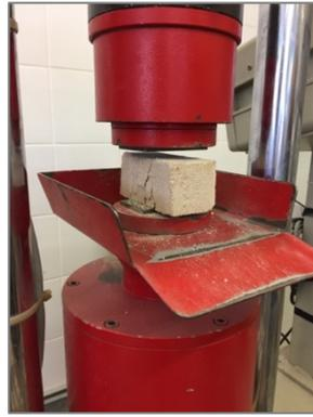
**Figura 5.8 - Ensaio de compressão de provetes de argamassa**
