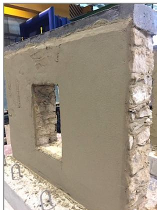
**Figura 5.4 - Parede de alvenaria rebocada**
