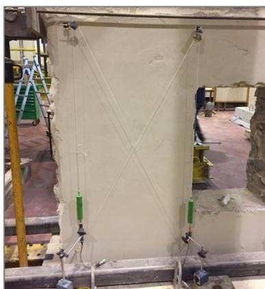
**Figura 5.22 - Sistema de pesos, fios e roldanas**
