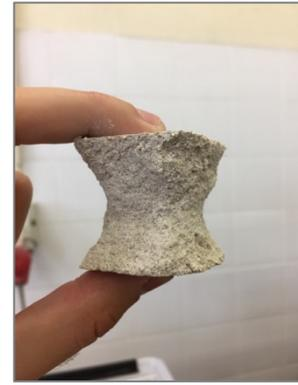
**Figura 5.9 - Superfície de rotura do ensaio de compressão**
