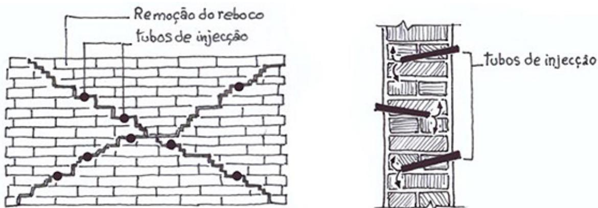
Figura 3.6 - Disposição dos tubos de injeção (Cabrita, 2010)
