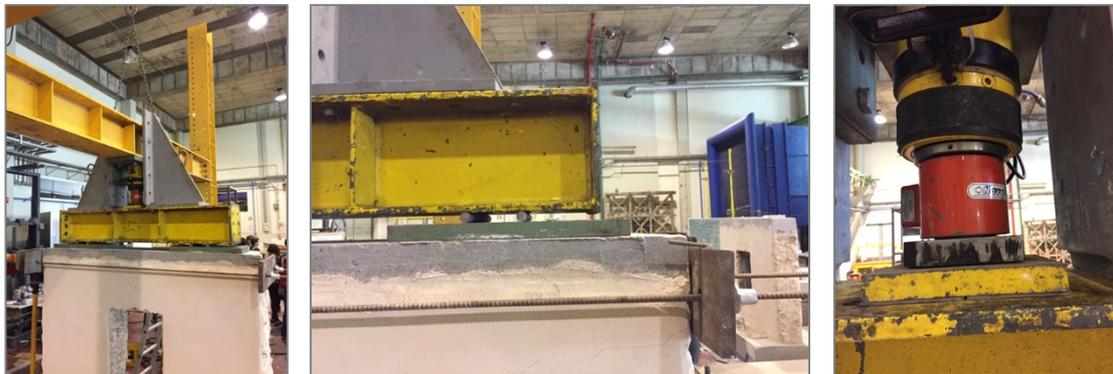
**Figura 5.15 - Sistema de aplicação da carga vertical na parede**
