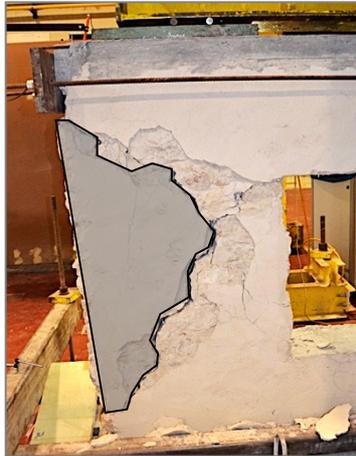
**Figura 5.43 - Separação da parcela de alvenaria**
